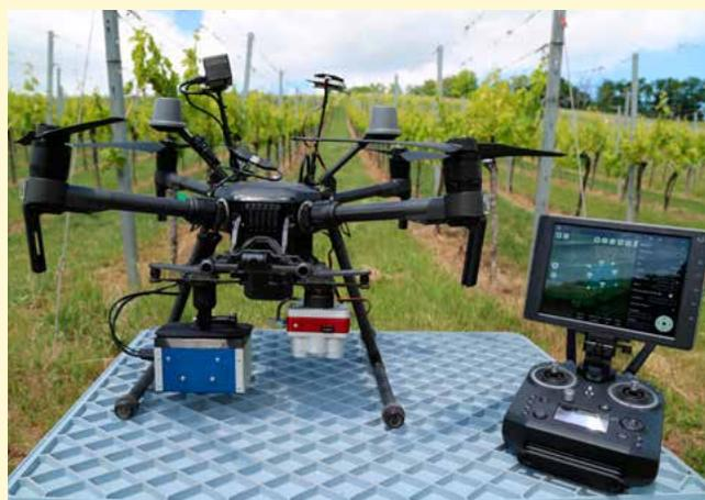
Abb. 1: Das UAV DJI Matrice 210 V2 RTK mit den Multispektralkameras Tetracam Macaw (links) und MicaSense Altum (rechts) sowie Fernsteuerung mit Tablet.
