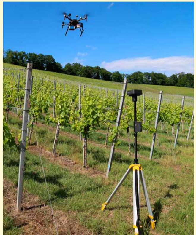
Abb. 3: Das UAV DJI Matrice 210 V2 RTK in der Luft mit RTK-Station.
